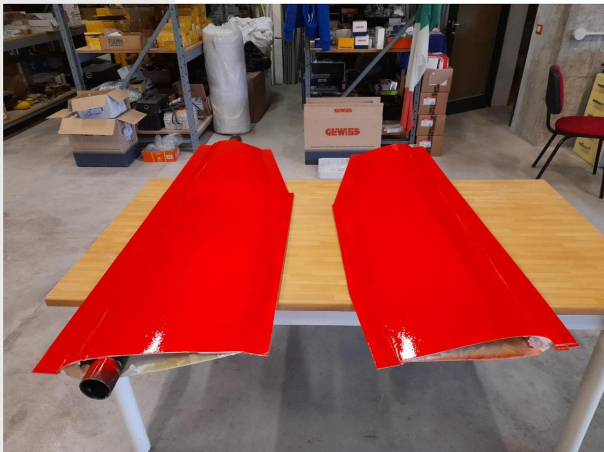
Costruzione del lato dx del tronco di coda (soffovuoto e prima stampata)
