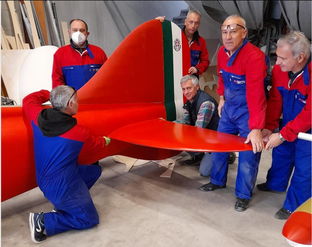
Tronco di coda: primo assemblaggio completo
