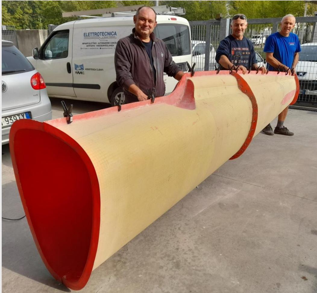
Preparazione stampata tronco di coda fusoliera destro
